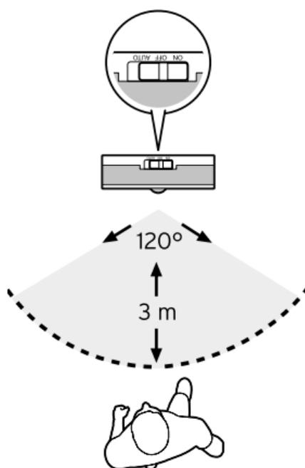
**ON** Schieben Sie den Schalter auf **ON**, um die Leuchte dauerhaft einzuschalten.
