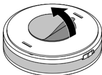
2. Ziehen Sie die Schutzfolie von der Rückseite des Klebepads ab.
