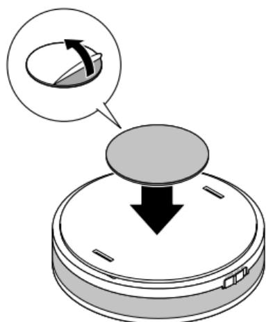
1. Ziehen Sie die Schutzfolie vom Klebepad ab und drücken Sie das Klebepad fest mittig auf die Rückseite der Wandhalterung.
