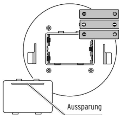
2. Haken Sie an der Ausparung unter den Batteriefachdeckel und heben Sie ihn nach oben ab.
