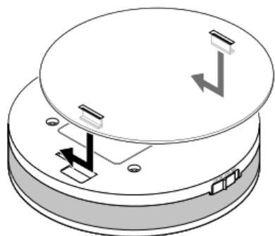
5. Setzen Sie die Wandhalterung wieder wie abgebildet auf die Rückseite auf und schieben Sie sie wie zur Seite. Sie muss spürbar einrasten.
